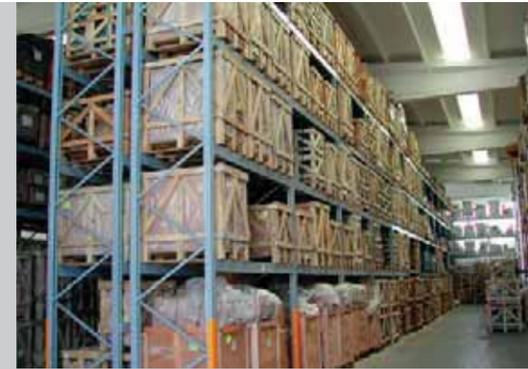
Gli scaffali per l'immagazzinaggio di pallets a semplice e doppia profondità, serviti da carrello elevatore, permettono una selezione rapida del prodotto immagazzinato.
